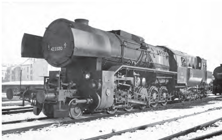
1E-Heissdampf-Zwillings-Güterzuglokomotive Reihe 42; gebaut 1943–1945.
