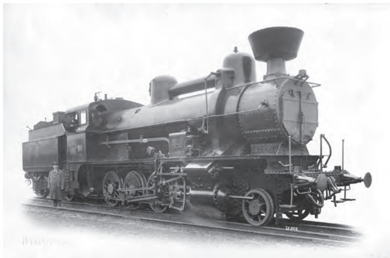
1D- Nassdampf- Verbund- Güterzuglokomotive Reihe 170, diese wurde in Österreich in über 800 Stück hergestellt, auch als Kriegslokomotive bezeichnet, da sie im Ersten Weltkrieg besondere Verwendung fand; gebaut 1897–1919.
