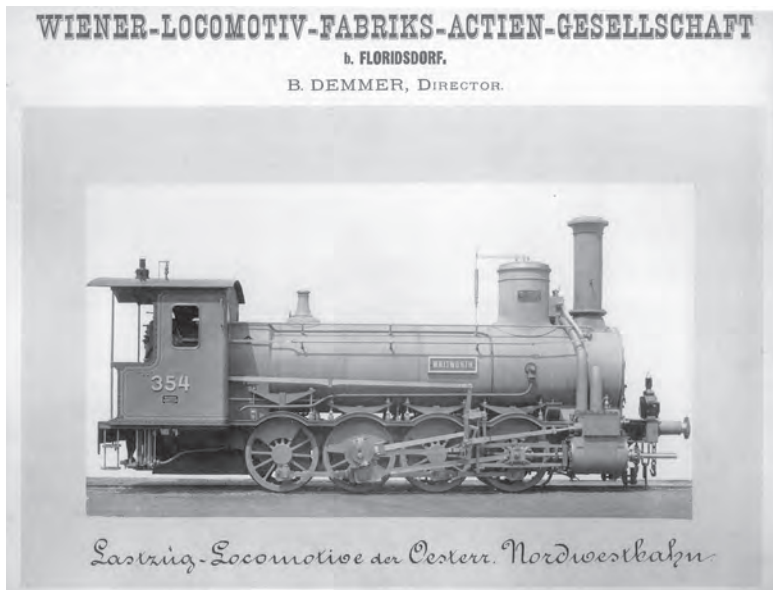
D-Nassdampf-2 Zylinder- Güterzuglokomotive Reihe VIIb WHITWORTH der österr. Nordwestbahn; gebaut 1874
