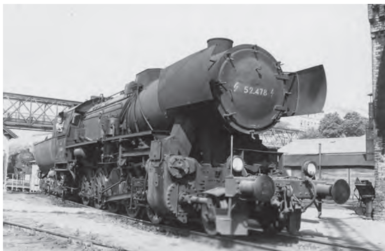
1E- Heissdampf-Zwillings-Güterzuglokomotive Reihe 52, als die Kriegslokomotive des Zweiten Weltkriegs bezeichnet; gebaut 1943–1944.
