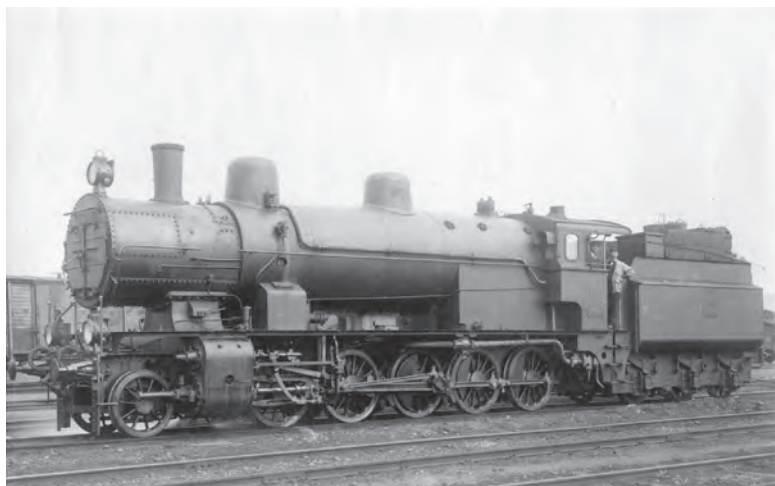
1E-Heissdampf-Zwillings-Güterzuglokomotive Reihe 81 mit verlängerter Rauchkammer zur Aufnahme eines Abgas-Speisewasservorwärmers; gebaut 1922.
