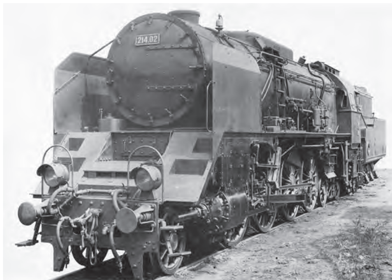
1D2-Heissdampf-Zwillings-Schnellzuglokomotive Reihe 214; gebaut 1928–1936.
