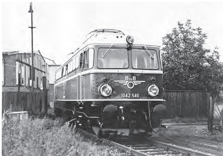
Elektrolokomotive 1042.540, die letzte in der Lofag gebaute Lokomotive; 1969.
