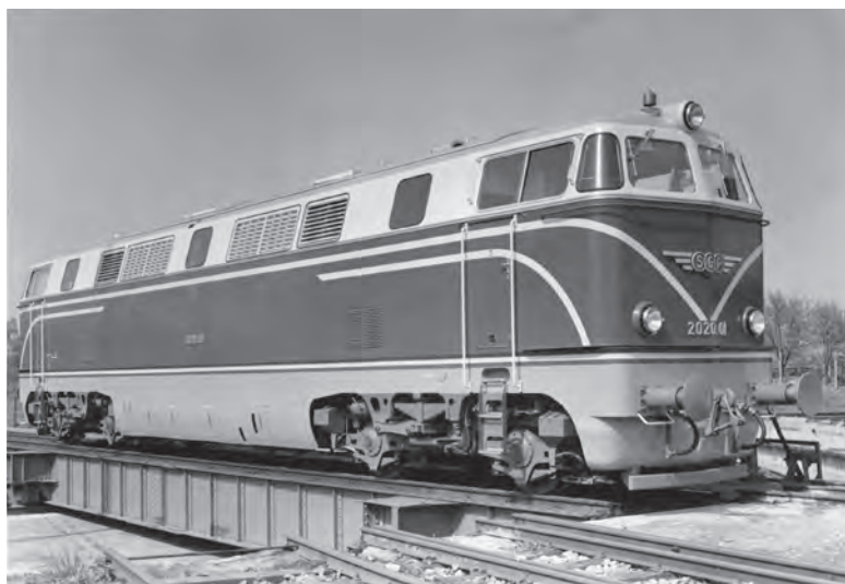
BB dieselhydraulische Lokomotive 2020.01; gebaut 1960.
